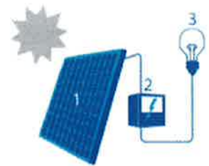
1. Zonnepaneel | 2. Omvormer | 3. Elektrische toestellen
